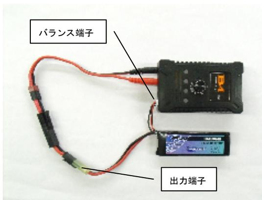
出力端子のみで充電を行うファースト充電は危険ですので、必ずバランス端子を併用もしくは、バランス端子のみで充電する形式で、バランス充電を行ってください。充電には、必ずOPTION No. 1製LiPoバッテリー専用タイプをご使用ください。
