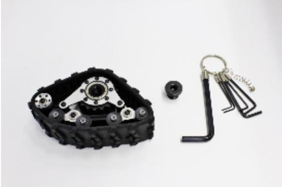
6mm の六角レンチを使用してナットキャップをキャタピラ本体から取り外します。
