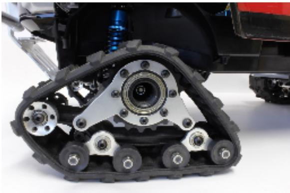
R/Cカーに付属している4mm ナットで、キャタピラを装着します。
