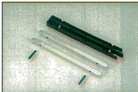
④ストック端子を固定しているピン2本をケースから引き抜いてフレームから端子を取り出します。
