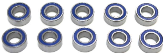
OPTION No.1 製のラバーシールボールベアリングは、高精度で内部抵抗が少なく、駆動系などに使用することでフリクションロスを低減し安定した回転を得ることができます。側面部分をラバーシールとすることで高い防塵性を発揮。オフロードカー等に最適です。
