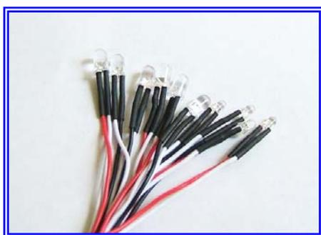
ステアリングやスロットル操作に連動して点灯、点滅するラジコンカー用LEDライト・システムです。
