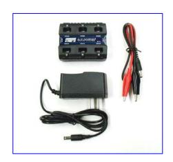
1セル(3.7V)のリポバッテリーを6個同時に充電することが可能です。 AC100V電源、DC12V電源、USBから使用できます。\*USBコードは別売です。 LiPoバッテリーに最適化したICコントロールチップを搭載。 LEDの色で充電ステータスがひと目で判ります。
