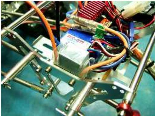
ツインモーター専用クローラーシャーシに装着し、リヤモーターの駆動を制御する電子式のDIG (ディグ) です。機械式DIGに比べ、軽量かつコンパクトな設計です。取付けもいたって簡単！ON状態でフロントモーターのみ駆動し、リヤモーターは停止状態となりますので、狭いエリアでも小回りが効き、狙ったラインをトレースできるすぐれものです。(フロントモーターに使用することも可能です。)
