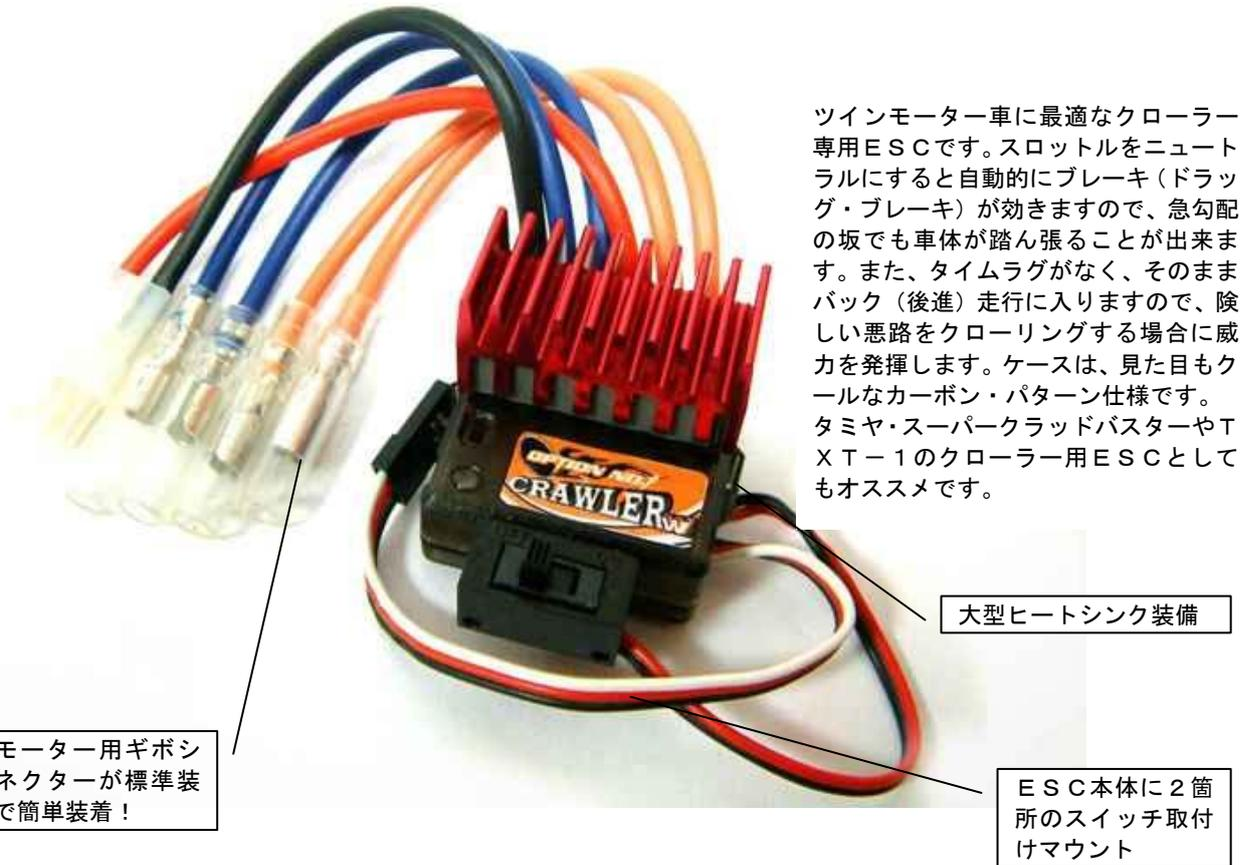
ツインモーター車に最適なクローラー専用ESCです。スロットルをニュートラルにすると自動的にブレーキ（ドラッグ・ブレーキ）が効きますので、急勾配の坂でも車体が踏ん張ることが出来ます。また、タイムラグがなく、そのままバック（後進）走行に入りますので、険しい悪路をクローリングする場合に威力を発揮します。ケースは、見た目もクールなカーボン・パターン仕様です。タミヤ・スーパークラッドバスターやT×T-1のクローラー用ESCとしてもオススメです。
