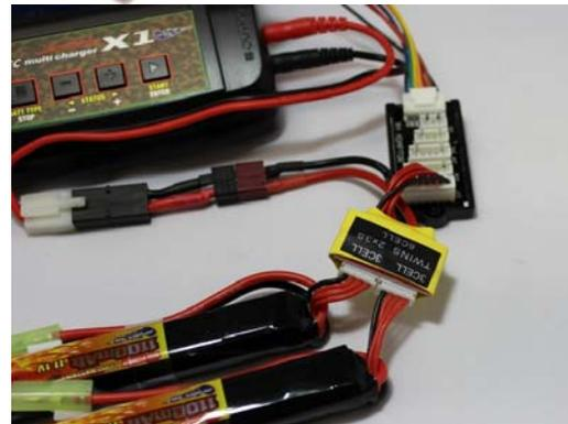
**ツインアダプターは、リチウム電池の 2 本同時充電が可能になる変換アダプターです。**
