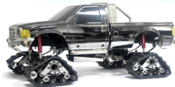
タミヤ CC01 シリーズとハイリフトシリーズに無加工で装着できるキャタピラユニットです。キャタピラは車輛の重量が履帯全体にかかるために接地圧が小さくなり、柔らかい地面や雪上でも沈み込みにくく、また多少の起伏や穴なども履帯越しに転輪が通るためにスムーズに通行する事ができます。
