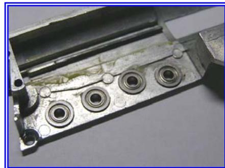
ノーマルのプラベアリングをこのボールベアリングに交換するだけで
