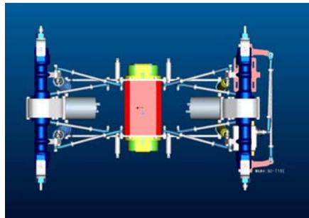
幾度のテスト走行の結果、ホイールベースをショート化しギャップ走破性が向上。
