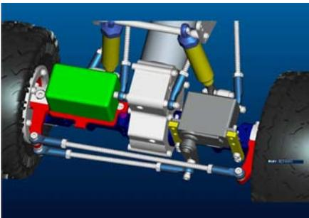
オール金属のホーシングは、抜群の安定感と登坂力を発揮。全幅をナロー&スリム化し腹下のクリアランスを確保。
